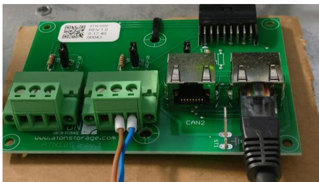
Figura 2 – Collegamento porta “CAN1” con cavo Ethernet intestato con spina tipo RJ45
