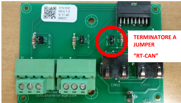
Figura 3 – Scheda ATN105 presente su ogni accumulatore: terminatore a jumper “RT-CAN”
